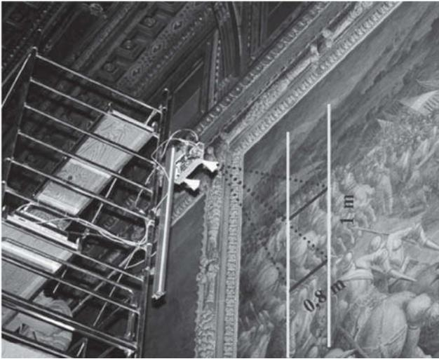
**Fig. 4** – La strumentazione radar sviluppata dall'Università di Firenze durante le campagne di misura nel Salone dei Cinquecento.
