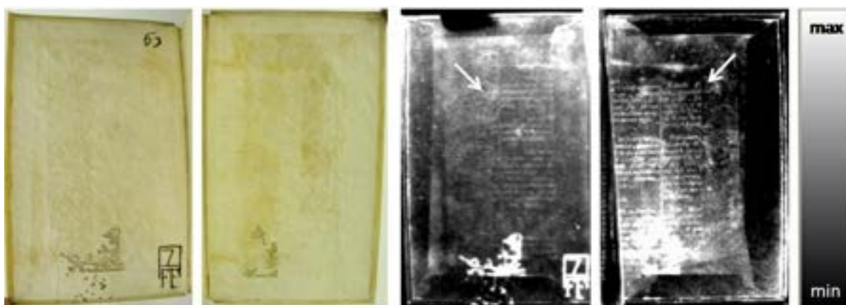
Figura 2, 3, 4 e 5. Controguardia anteriore e posteriore del volume FF.7.61 conservato presso la Biblioteca Angelica di Roma: immagini fotografiche e relativi termogrammi dove le frecce indicano le aree di testo.
