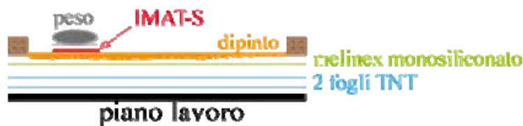
Figura 11. Schema di successione degli strati
