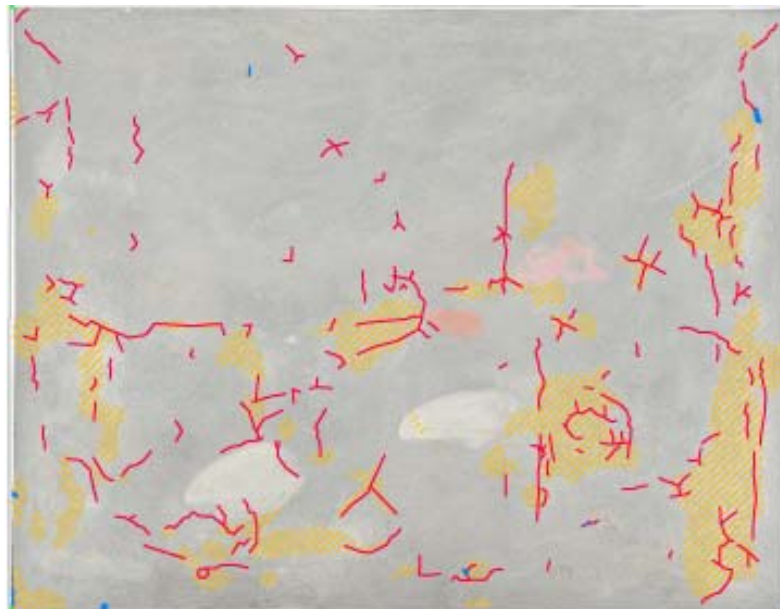
Figura 9. Documentazione grafica delle fessurazioni e delle aree reintegrate nell’intervento di Turcato
