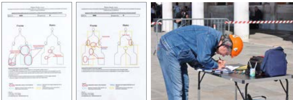
Figura 9-10 - Schede descrittive dello stato conservativo e della messa in sicurezza della merlatura di Palazzo Ducale e fase di acquisizione dati durante l'attività di ispezione diretta
