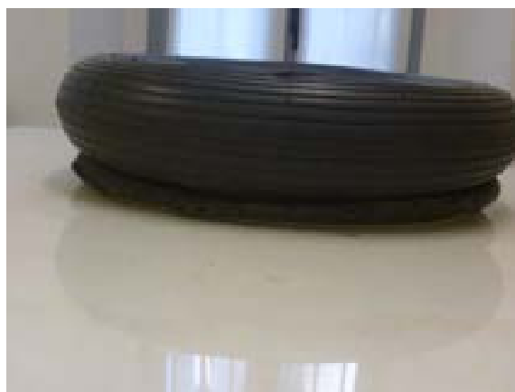
Figura 3. Particolare della lesione della camera d'aria
