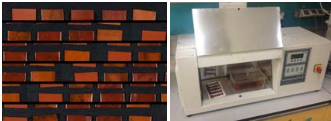
Figure 11 e 12. Preparazione dei campioni di camere d'aria, 5 senza trattamento e 25 trattati con 5 consolidanti diversi, suddivisi per tipologie (colonne) e trattamenti (righe). Sistemazione dei campioni in solar box.
