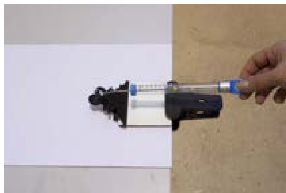
Fig. 8: Provini degli adesivi nella fase di peeling test
