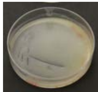
Figura 6. Campione contenente colla con evidente colonizzazione fungina e campione contenente colla ed MB2 - assenza di colonizzazione
