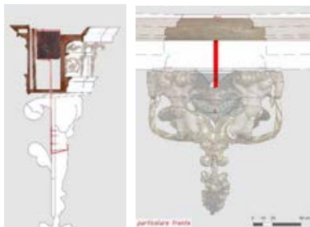
Fig 26 Grafico del sistema di costruzione e di agganci del tabellone
