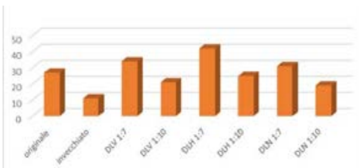
Fig. 23 Le prove di resistenza alla trazione dei diversi consolidanti testati.
