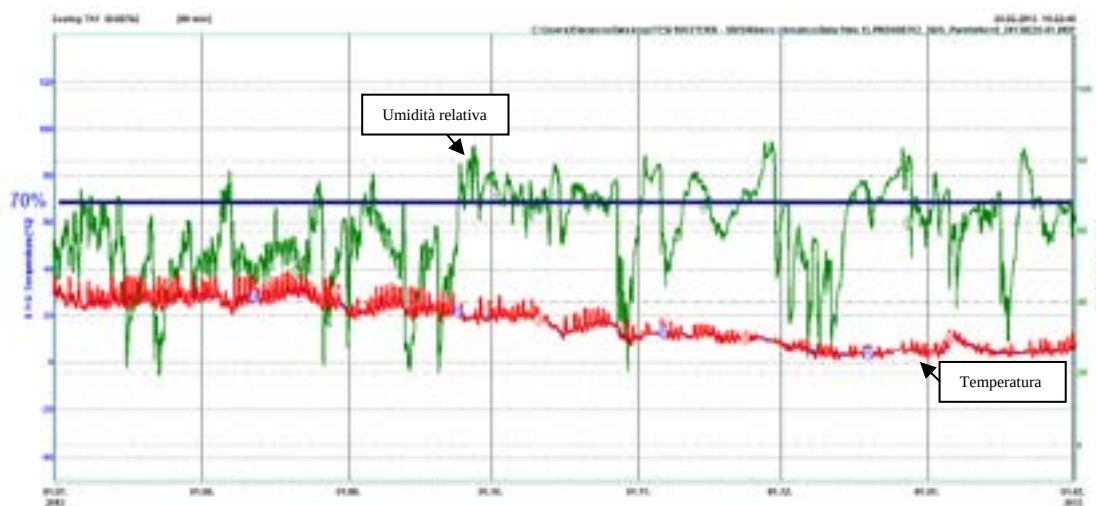
Figura 8. Rilievo della umidità relativa e della temperatura all’interno della chiesa (dal 1 luglio 2012 al 1 febbraio 2013). Si rileva che i valori di umidità relativa oltrepassano frequentemente il valore di 70% (indicato dalla linea più scura al centro).
