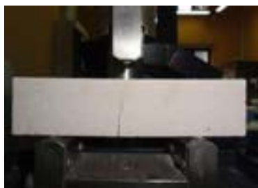
Figura 6. Rottura tipica in mezzeria del provino
