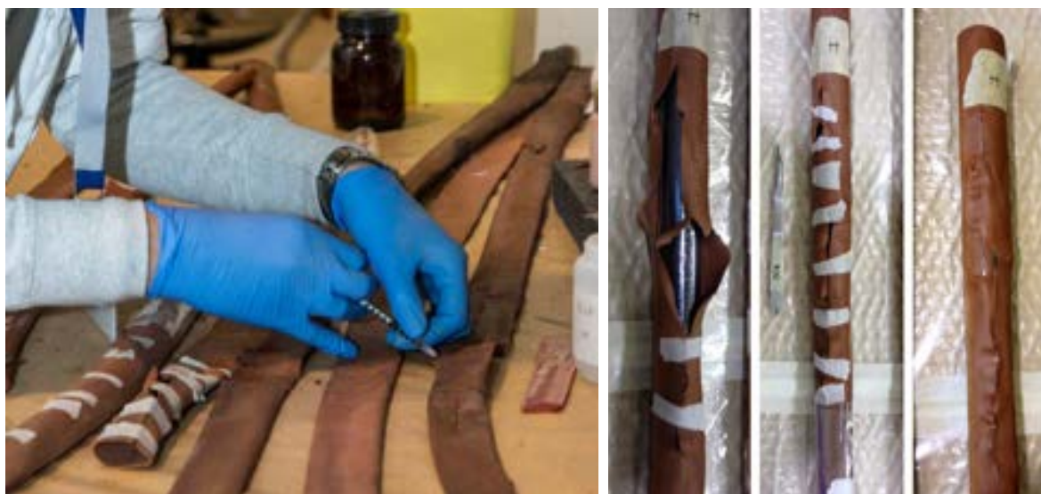
Figure 16 e 17. Consolidamento strutturale delle gomme tramite iniezioni localizzate di EVA 42-60 disciolto al 5% in Cicloesano con aggiunta del 5% di Tinuvin B75. Evoluzione del trattamento consolidante su una camera d’aria di “Presagi di Birnam”.
