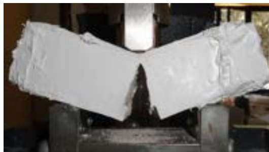
Figura 12. Rottura dei provini per la prova di assorbimento per capillarità
