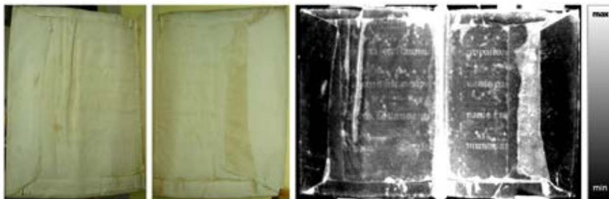
Figura 15, 16, 17 e 18. Controguardia anteriore e posteriore del manoscritto E.28. Il conservato presso la Biblioteca Vallicelliana di Roma: immagini fotografiche e relativi termogrammi.
