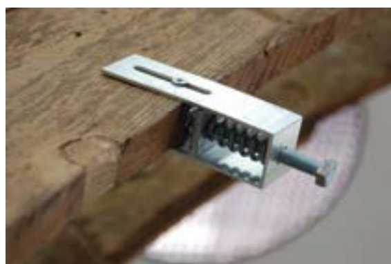
Figura 4. Applicazione al vecchio telaio del sistema di tensionamento
