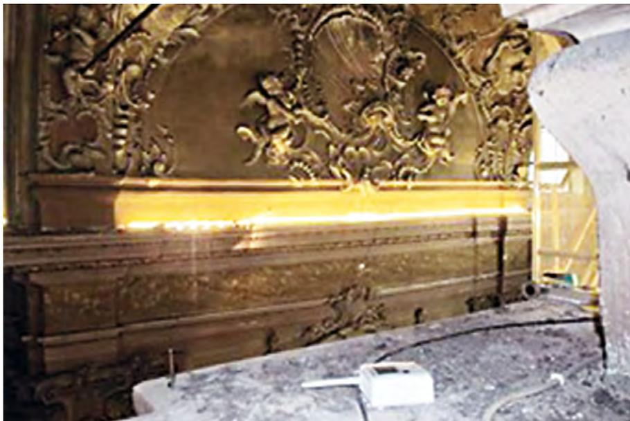
**Fig. 8** - Monitoraggio termoisometrico, posizione dello strumento DL2 sopra al cornicione all'angolo tra aula e presbiterio.
