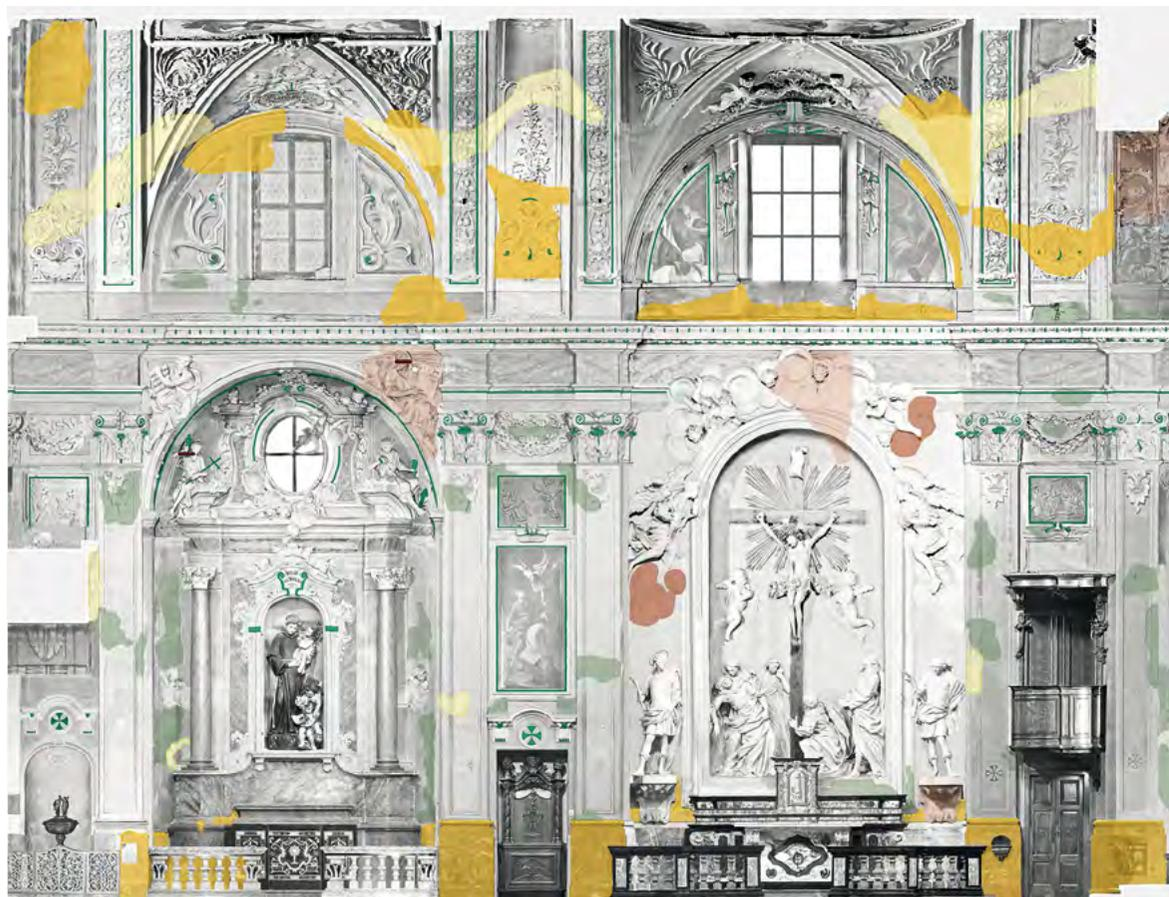
Fig. 12 - Prospetto interno nord, rilievo delle patologie di degrado. (Dastu, Politecnico di Milano, 2012).
