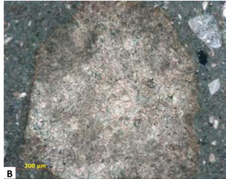
**Fig. 19** - Micrografie XPOL, ingrandimento 5X. **A)** Frammento di dolomite poco cotto, si nota come il bordo si sfuma nel legante circostante, indicando una parziale reazione. Il frammento però conserva le strutture tipiche di un calcare dolomitico con i cristalli di forma romboedrica. **B)** in questo frammento invece la cottura è stata più spinta, infatti si nota che le strutture tipiche di un calcare dolomitico rimangono solo come relitti.
