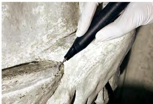
**Fig. 10** - Castel San Pietro, chiesa di Sant'Eusebio, cappella del Crocifisso: intervento di pulitura basato sulle proprietà supportanti dell'Agar, stesura del Nevek.
