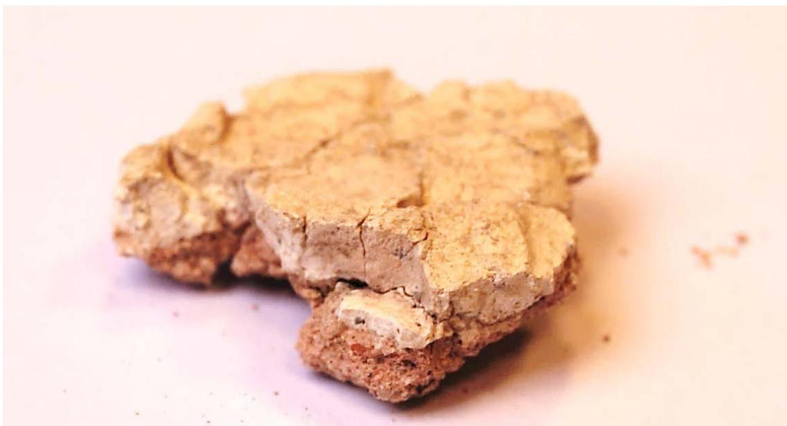
Fig. II.63 - Particolare proveniente dal retro del lacerto 1 proveniente dall'ambiente E: si osserva la successione stratigrafica tra una porzione di *nucleus*, strato inferiore tendente al rosso, e malta d'allettamento, di colore bianco.
