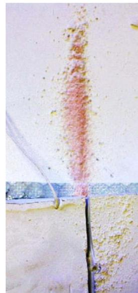
Fig. III.35 - Il colore rosato indica il raggiungimento della camicia.
