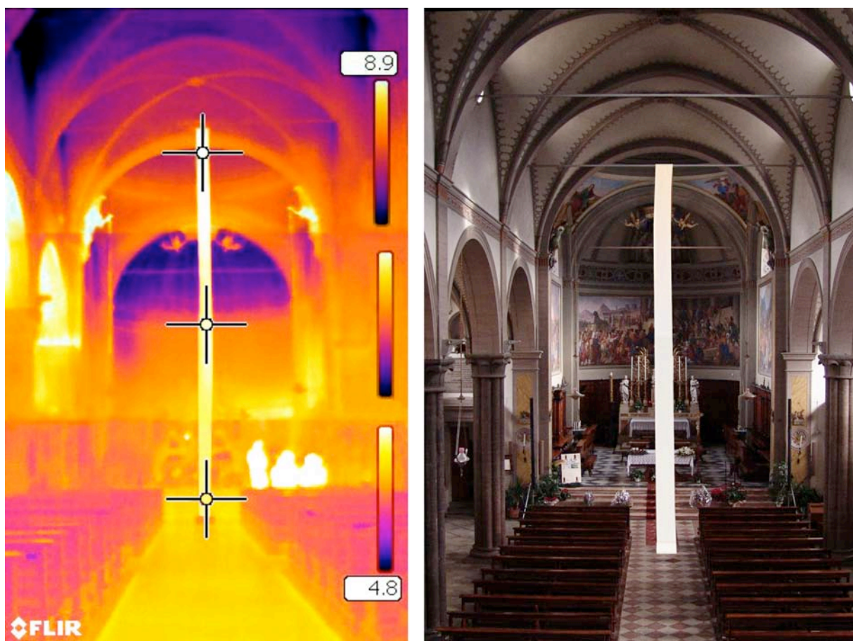
Fig. 6 - Foto all'infrarosso termico (a) e in luce visibile (b) dell'interno di una chiesa per verificare l'efficienza del sistema di riscaldamento e l'impatto sui vari beni culturali.
