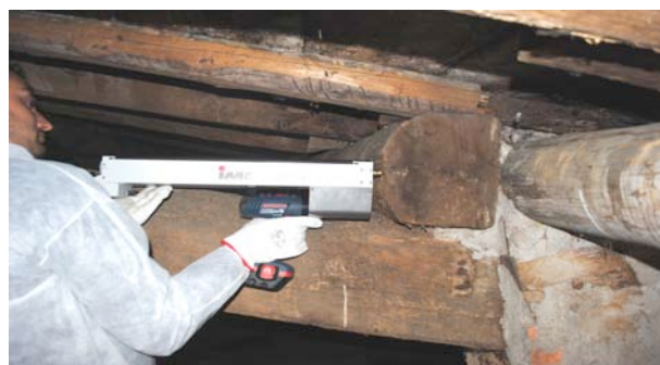
Fig. 3 – Castello di Lurano: analisi, con resistografo, delle travi in legno
