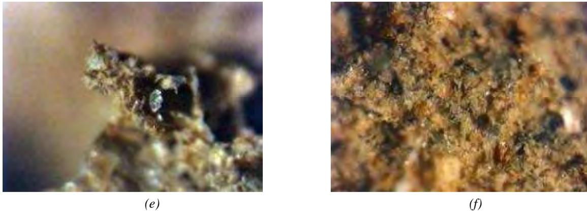
*Figura 16 - Campioni prelevati da provini trattati con fosfocitrato alla concentrazione B (a sinistra) e M (a destra).
