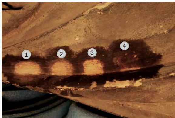
Fig. 3 - Effetto di impacchi solventi, a parità di tempo di applicazione e di materiale supportante (polpa di cellulosa Arbocel): 1) ammonio carbonato al 10%; 2) ammonio carbonato in soluzione satura; 3)  $\frac{1}{2}$  ammonio carbonato in soluzione satura +  $\frac{1}{2}$  EDTA al 10%; 4) AB57.
