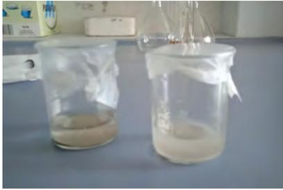
Fig. 3 - Sospensione ottenuta dopo sonicazione del campione Croste Nere (sx) e Sali (dx).
