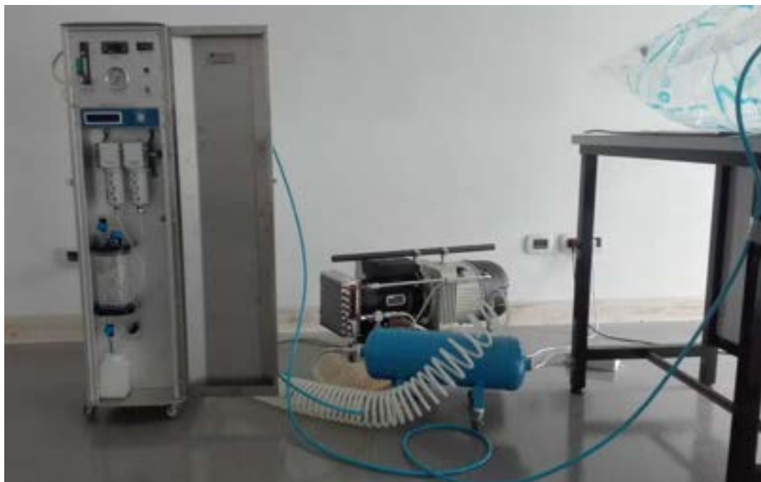
Figura 16. Sistema Velox 1000 per trattamenti in anossia con atmosfera modificata
