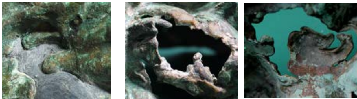
Figura 15-16-17: dettagli delle superfici interne ed esterne in corrispondenza delle lacune del getto. Il profilo curvilineo delle sezioni attesta la presenza delle lacune già nel modello in cera.
