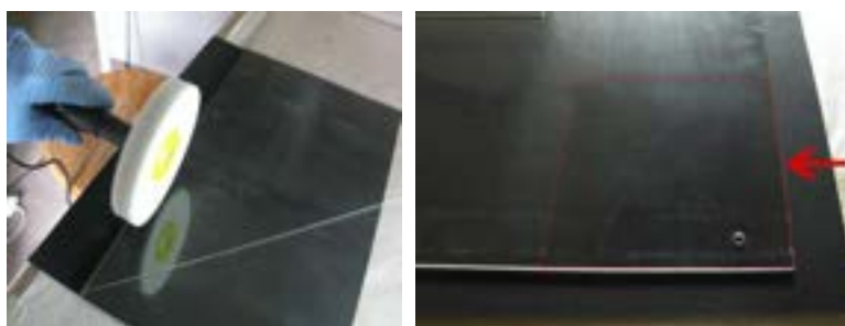
Figura 8. Trattamento di lucidatura e tassello in corso d'opera su una zona di opacizzazione dovuta ad abrasioni superficiali.
