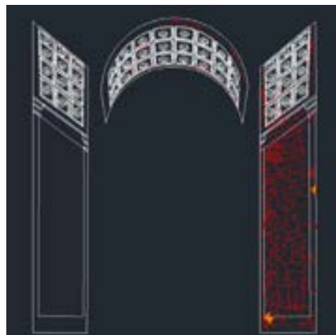
Figura 2. Quadro fessurativo dell'intradosso in rosso e la mancanze di maggior entità in arancione sede dell'incendio.
