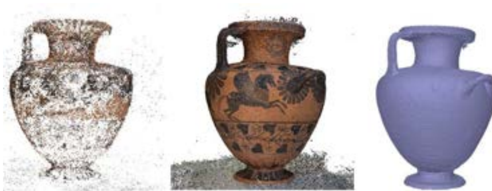
Figura 2. Nuvola di punti sparsa ( sparse points cloud ), nuvola di punti densa ( dense points cloud ) e mesh triangolare
