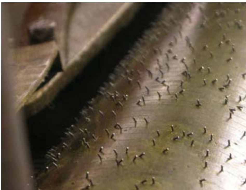
Figura 9. Dettaglio del cilindro con lo stato delle coppiglie
