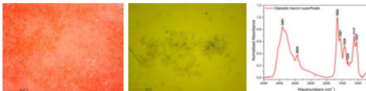
Figura 6. Da sinistra: immagini in microscopia portatile a 50X dei depositi superficiali sui laminati; spettro FTIR del deposito superficiale
