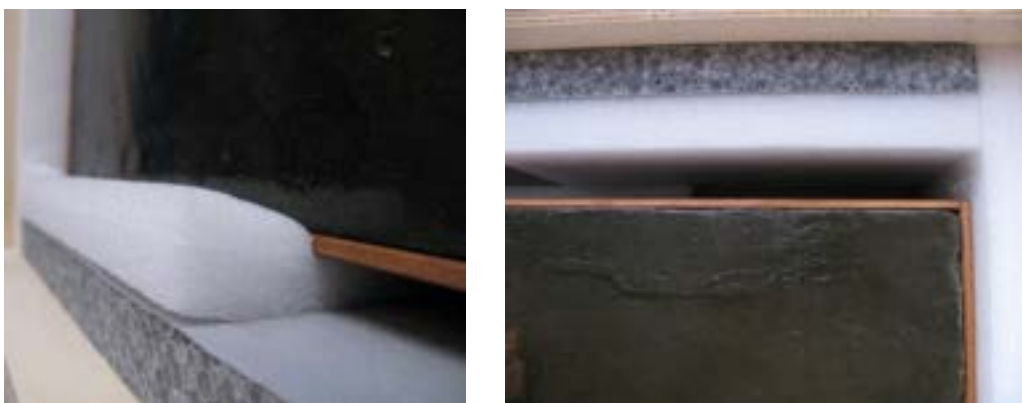
Figura 1. Il peso dell'opera causa la compressione del materiale ammortizzante e, se questo è troppo morbido, la sua deformazione. Nel caso illustrato dall'immagine l'opera non risulta più ben bloccata all'interno della cassa perché nella parte superiore si viene a creare uno spazio. In queste condizioni, le sollecitazioni durante il trasporto faranno sobbalzare l'opera all'interno dell'imballaggio. In genere, quando ci si accorge dell'errore, per bloccare l'opera si inserisce nelle parti che risultano vuote del materiale ammortizzante a contrasto; tuttavia questi interventi d'urgenza sono un segno di una carenza progettuale e possibilmente poco efficaci.
