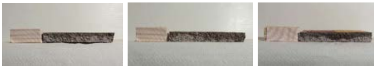
Figure 6-8. Test di penetrazione dell'acqua nell'intonaco dopo 1 h di applicazione: Fig. 6 Nevek®; Fig. 7 Agar Art, Fig. 8 Arbocel® BC 200
