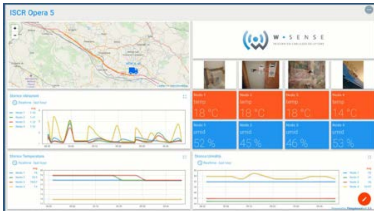
Figura 5. Esempio di schermata relativa a un trasporto monitorato in tempo reale: in alto a sinistra è riportata la posizione del camion. Per ogni sensore è costantemente visualizzata temperatura e umidità. Sui grafici è possibile leggere lo storico delle vibrazioni, temperatura e umidità, rilevate nell'ultimo lasso temporale (un'ora in questo esempio).
