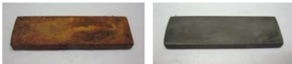
Figure 4 e 5. Provini di ferro inglobati in agar all'1% (a sinistra) e al 5% (a destra) ed estratti dopo 2 mesi
