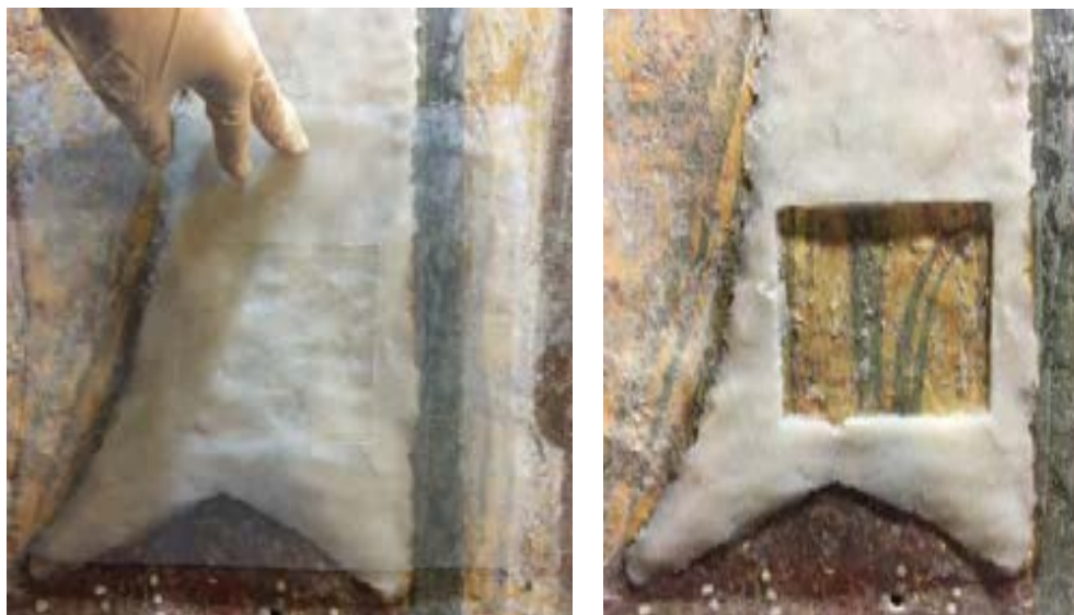
Figure 11 e 12. Rimozione tramite mascherina in polietilene della compressa di Nevek® per la misura di conducibilità elettrica
