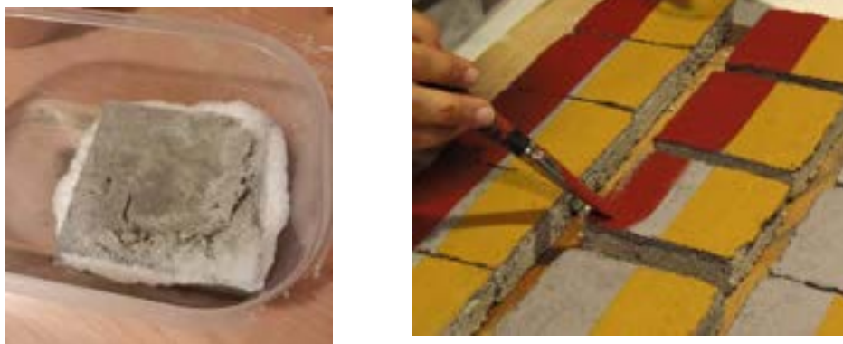
Figure 2-3 Uno dei provini in pietra serena durante l'invecchiamento salino. Stesura della pellicola pittorica sui provini d'intonaco (foto L-Mangiapelo, Michela Bassi)
