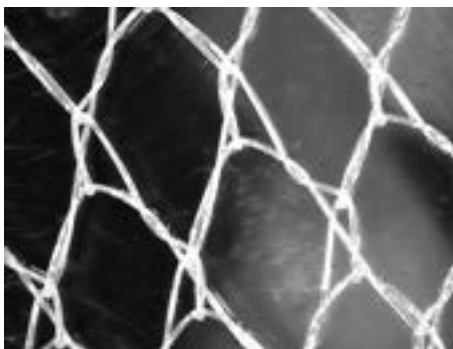
Figura 5. Immagine al microscopio Dino-Lite - orditura del tulle ingrandimento 2X
