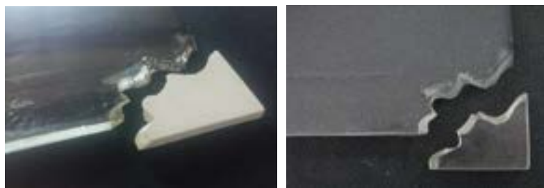
Figura 12 a e b. Calco positivo in gesso dentistico e inserto finale in resina epossidica dopo la colatura nel calco negativo in silicone.
