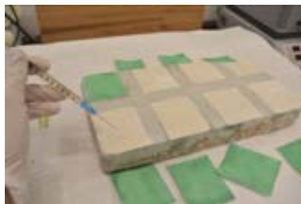
Figura 10. Pre-bagnatura con 0,5 ml di H 2 O demineralizzata per facilitare la distribuzione dell'adesivo nella porosità.
