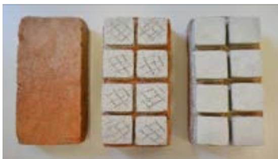
Figura 3. Realizzazione del supporto dei campioni di le Campora, dove sono visibili in successione il mattone grezzo, l'arriccio e l'intonaco.
