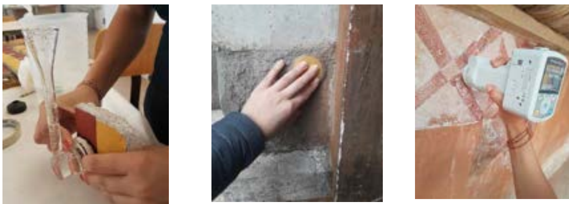
Figure 4-5-6 Alcuni test di controllo dei trattamenti effettuati sui provini e in situ: da sinistra, il tubo di Karsten, il test della spugna, il controllo colorimetrico (foto L. Mangiapelo, M.Bassi)
