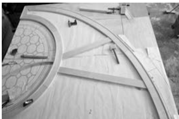
Figura 16. Costruzione del telaio sul profilo in scala 1:1
