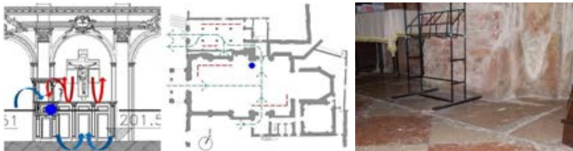
Figure 6 e 7. Localizzazione SIAP 7006 indicata con pallino blu: schema del flusso d'aria generato dall'attivazione dell'impianto di riscaldamento, le frecce rosse indicano l'uscita dell'aria calda in parte immediatamente ricircolata, a fianco pianta Chiesa Parrocchiale e attiguo ex-oratorio, le frecce indicano il percorso dell'aria rilevato in condizioni di porte spalancate per entrambi gli edifici, le zone leggermente più umide sono quelle tratteggiate in rosso. Lato Sud/Est particolare di degrado attacco muro e pavimenti con efflorescenza.
