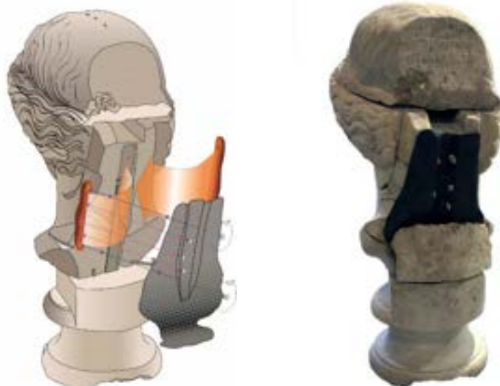
Figure 12 e 13. Progetto esecutivo (elaborazione grafica a cura di J. Russo). A destra, piastra in carbonio in posizione
