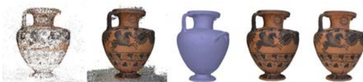
Figura 7. Hydria: nuvola di punti sparsa e densa, solid mesh e modello texturizzato
