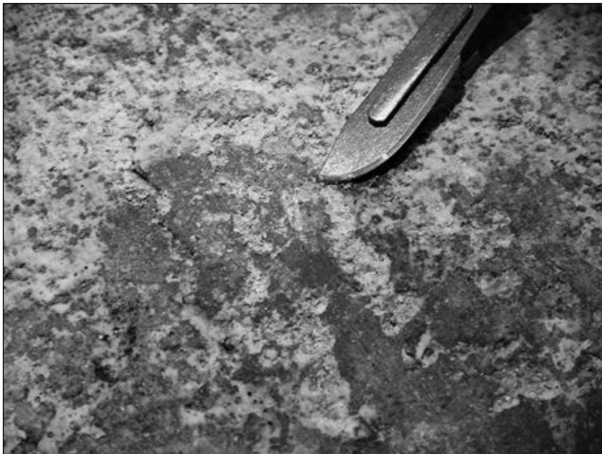
Un frammento di lamina d’oro riaffiora durante la sublimazione del Ciclododecano
