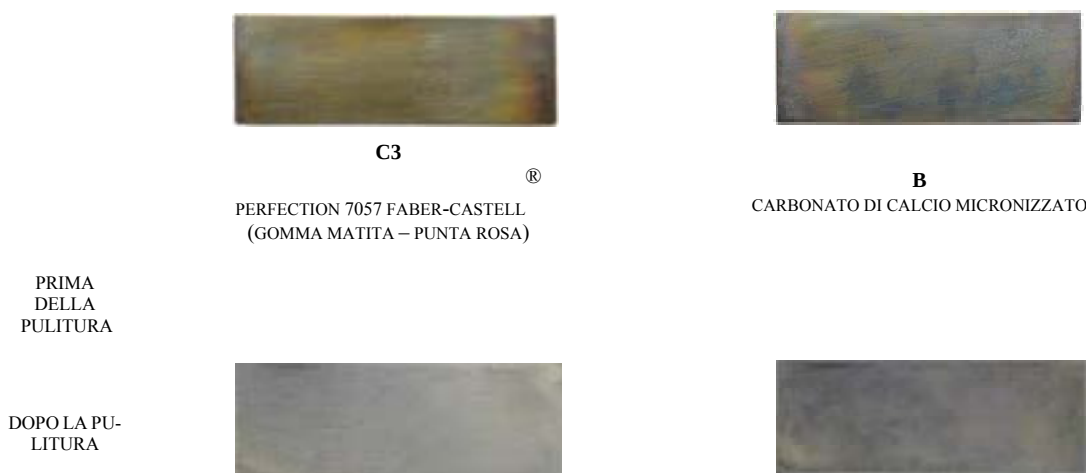
Figura 2. Sperimentazione tecniche di pulitura dell'argento: rimozione della solfurazione indotta su di un provino in argento mediante l'uso di una gomma (C3) e di una polvere abrasiva (B).
