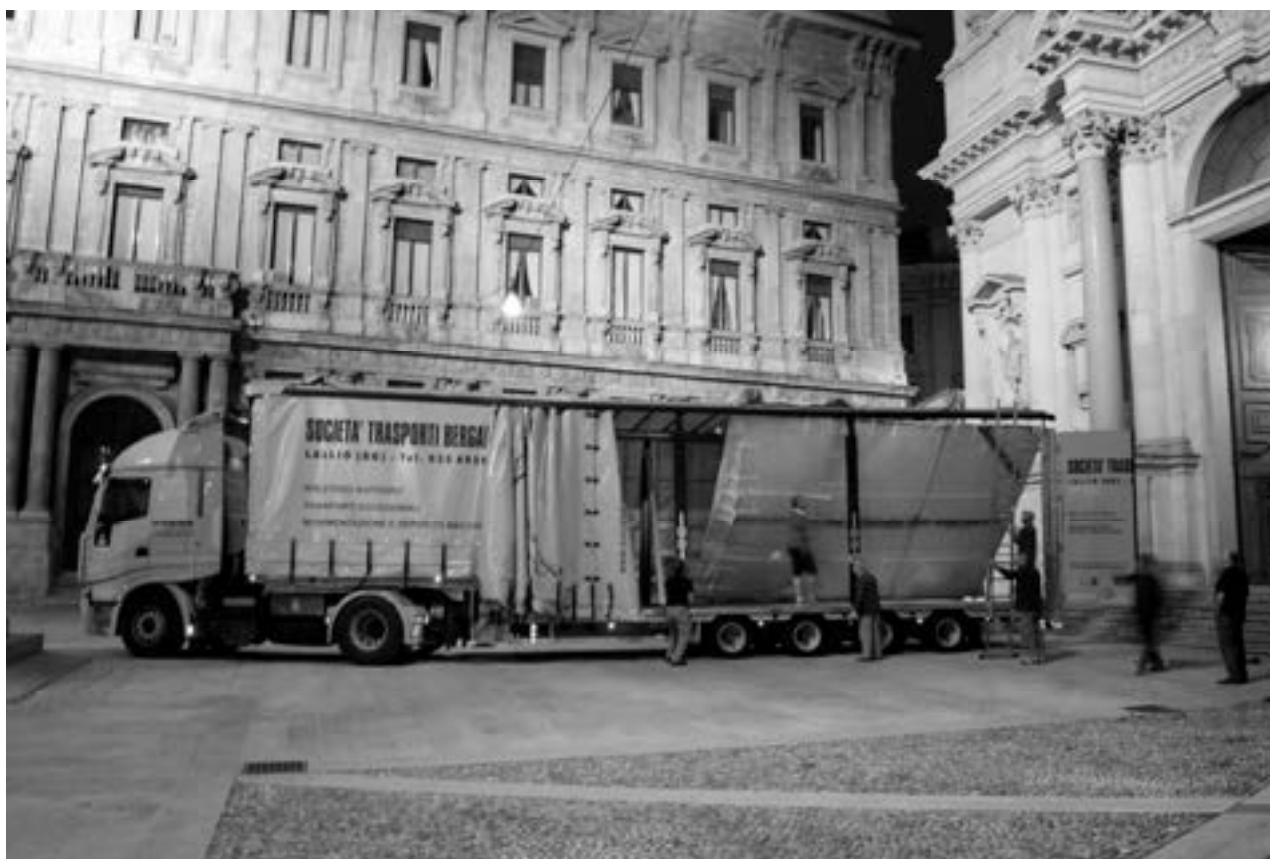
Fig. 10-11. L'automezzo con cassone ribassato e tetto regolabile
