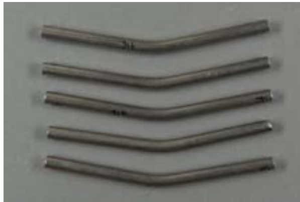
2. Campioni in acciaio deformati da un carico di 145 Kg
