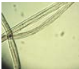
Figura 5. Indagine merceologica, riconoscimento fibra al microscopio ottico, ingrandimento 300x
