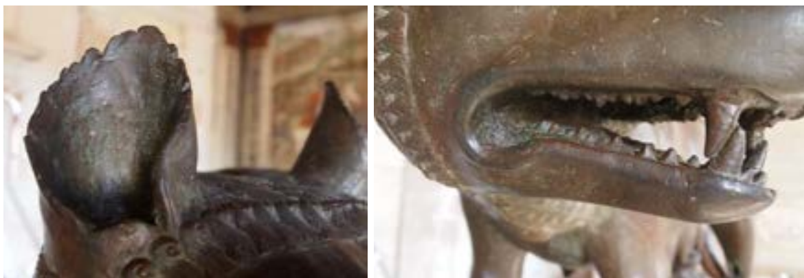
Figura 19 e Figura 20. Fotografie degli elementi aggettanti: le orecchie e i denti recano le tracce di una lavorazione diretta in cera confermata dai termogrammi che hanno evidenziato anche l'ottima qualità del getto in queste aree.
