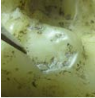
Figura 24. Aetas Aurea , convessità globulari della cera entro incavi, tipici indizi di vacuoli nella controforma in gelatina.
