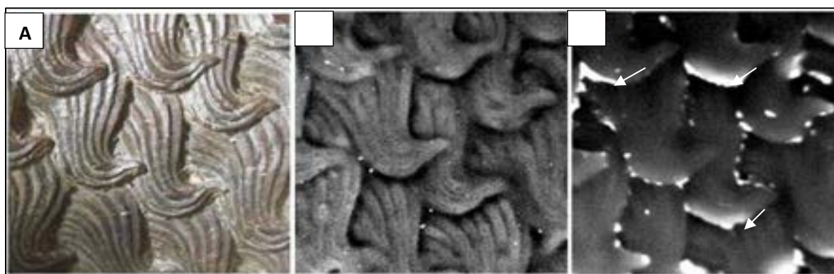
Figura 5. Fotografia (A) del pelame della Lupa Capitolina, termogrammi del calco contemporaneo (B) e dell'originale (C) della stessa area. Le frecce nel termogramma dell'originale indicano le discontinuità lungo i bordi.
