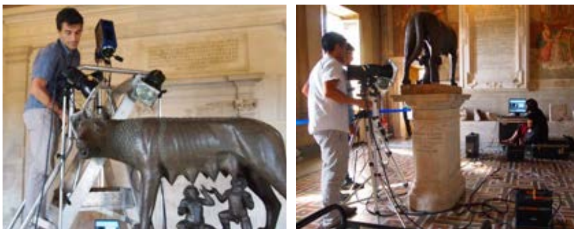
Figura 1 e Figura 2. Fasi di acquisizione dei termogrammi: a sinistra il posizionamento delle lampade e della termocamera, quest'ultima disposta ortogonalmente alla superficie; a destra la termocamera collegata ad un computer che permette, attraverso un software, di elaborare le immagini acquisite.
