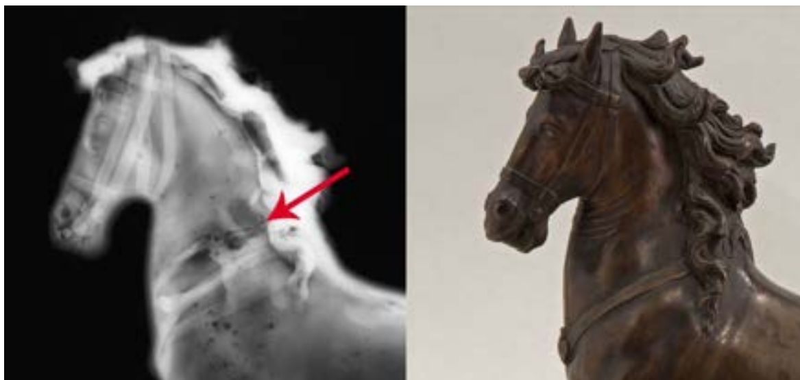
Figura 4. Il Cavallo in corvetta: esame RX ed immagine visibile di testa e attaccatura del corpo (la freccia indica la linea di giunzione)
