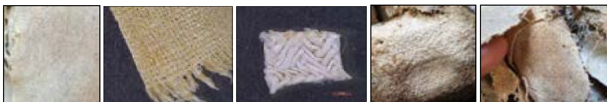
Figure 6, 7, 8, 9 e 10. Tipologia di armature differenti (a tela e diagonale) costituenti l’oggetto.
