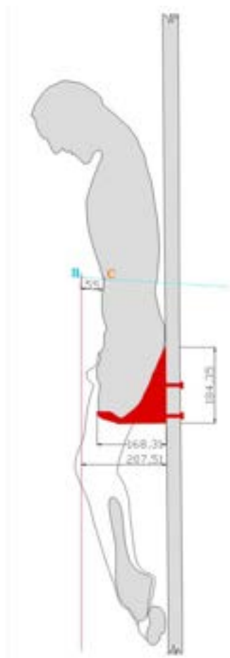
Figura 12. Sezione della scultura con il nuovo sistema di ancoraggio (in rosso)
