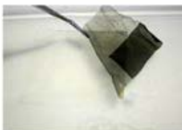
Figura 18, 19, 20: Distacco del frammento di emulsione dal supporto-acetato nel bagno di solventi
