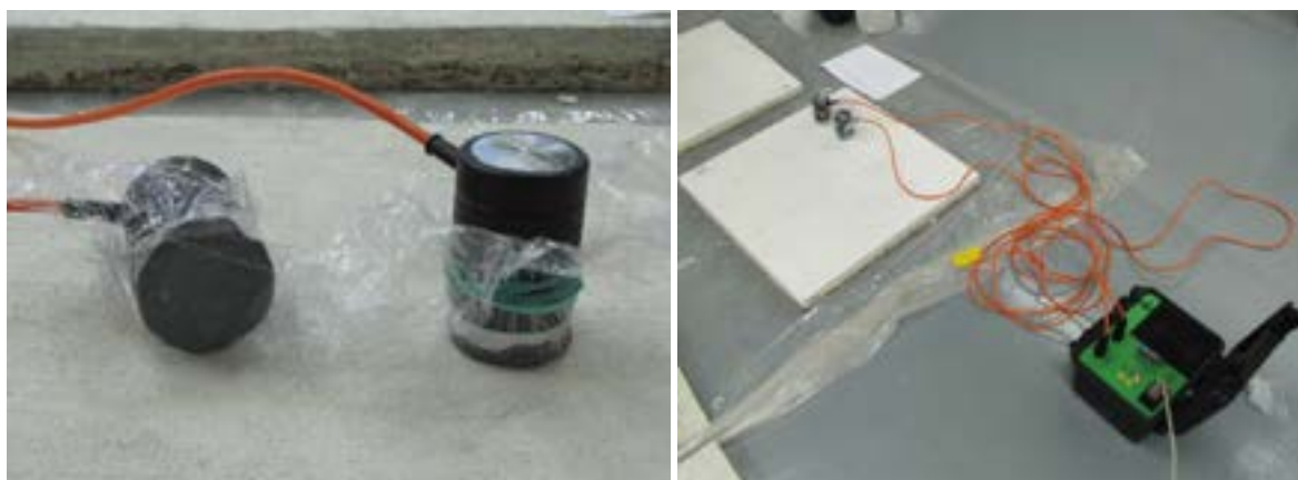
Figure 5 e 6. Indagini con strumentazione ultrasonica sui modelli di laboratorio, SUPSI luglio 2013, in collaborazione con Boviar s.r.l.
