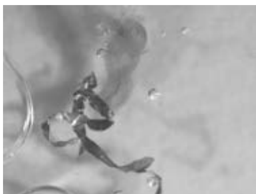
Figura 5 Particolare al microscopio ottico di un filato metallico della riccetta: si può osservare che la doratura è presente su entrambi i lati, elemento che indica una produzione tramite bagnatura e non battitura.
