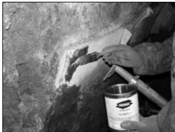
Ciclododecano applicato con spray ed a pennello
