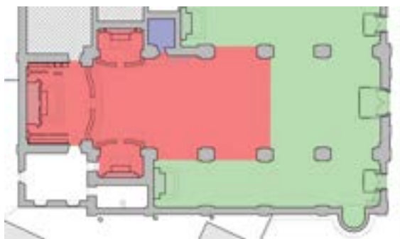
Figura 7. Pianta con indicazione delle fasi costruttive: in rosso la fase seicentesca, il blu il campanile e in verde quella novecentesca
