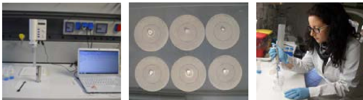
Figure 4, 5 e 6. Misura della viscosità dei gel; sistema di rilascio controllato della soluzione; colonizzazione dei gel da microorganismi.
