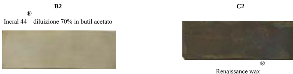
Figura 4. Sperimentazione sulla protezione dell'argento: provini con stesure protettive al termine del trattamento di solforazione artificiale. Nella figura sono messe a confronto le proprietà di protezione di una vernice acrilica e di una cera per evidenziare come quest'ultima, nelle condizioni di applicazione del presente studio, non abbia praticamente alcuna azione protettiva dell'argento.
