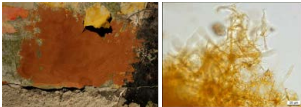
Figure 8 e 9 A sinistra, foto in luce visibile dell'attacco fungino. A destra: immagine al microscopio ottico ove sono ben visibili strutture filamentose riconducibili a ife di funghi.
