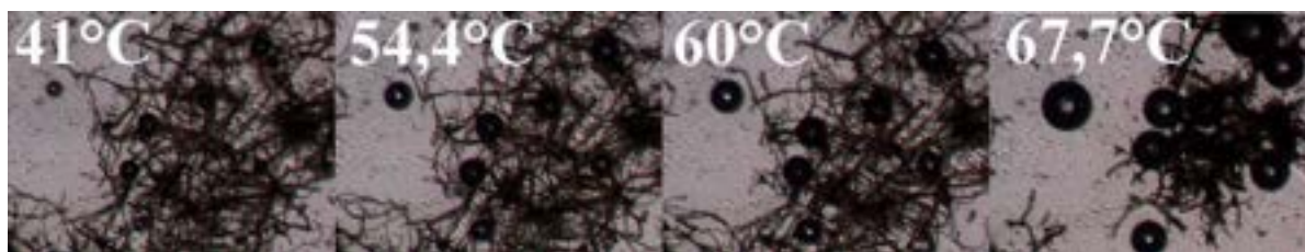
Figura 5. Misura della temperatura di contrazione su tavolo caldo. Prelievo 7.611, cuoio rosso.
