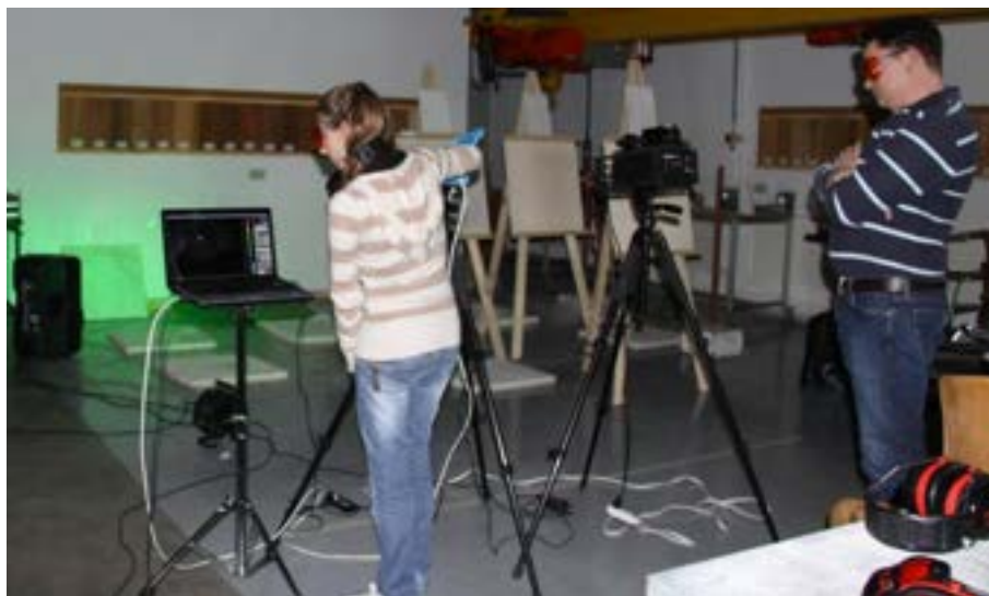
Figura 4. Indagini con Laser Speckle Interferometry sui modelli di laboratorio, SUPSI marzo 2013 in collaborazione con G.Chiari e D. Carson del Getty Conservation Institute
