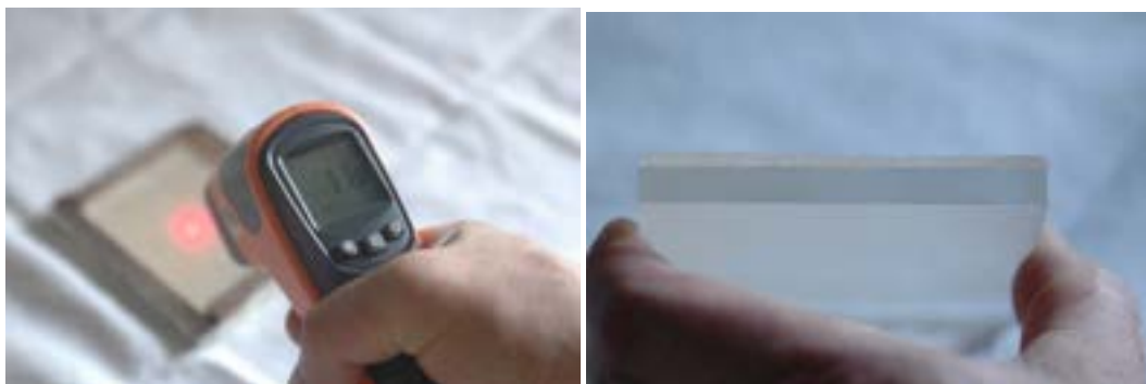
Figura 21 e 22. Misurazione della temperatura del gel sul plexiglas e spessore del gel sulla tavoletta di plexiglas
