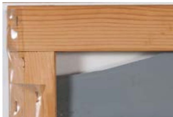
Figure 3 e 4. Particolari del taglio presente sulla quarta fascia (fronte) e punti di rottura in prossimità delle graffette metalliche (retro)
