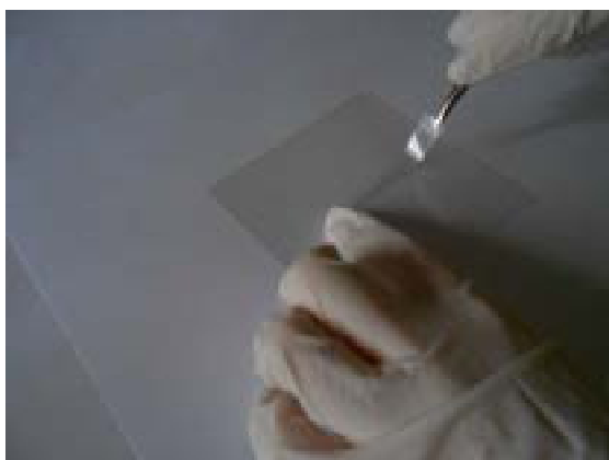
Figure 7 e 8. Test di incollaggio con toppina in film poliestere (applicazione della toppina sul provino) e filo di nylon (posizionamento sul provino del filo, a cavallo del taglio con andamento ondulatorio)
