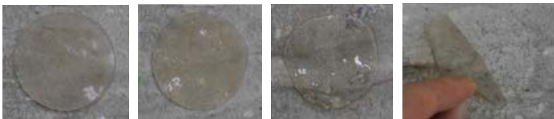
Figure da 22 a 25. Pulitura del tondo “ Eleonora De Fonseca Pimentel condotta al patibolo ” di Francesco Jerace, mediante impacco gelatinoso di Kona-Kanten , Kaku-Kanten , Tengusa . L'impacco gelatinoso di Tengusa è stato tenuto in posa per 20 minuti.
