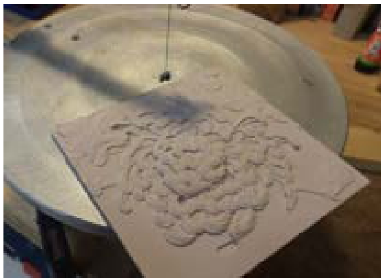
Figura 16. Crisantemo fresato su lastra di poliuretano, con in evidenza la porzione da traforare
