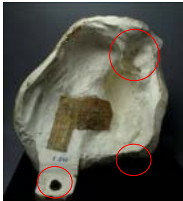
Figura 13. Aetas Aurea , veduta posteriore, "armatura metallica" del gesso e vincolo meccanico alla base lignea
